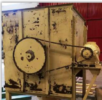
Mezcladora antes de reparación
